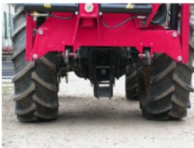
Basamento con luce di 70 cm da terra che permette di agganciare un rimorchio al traino originale del trattore
